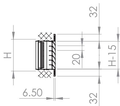
Odvodna rešetka OR-FK služi za dovod i odvod vazduha u sistemima ventilacije i klimatizacije. Sastoje se od jednog reda nepokretnih lamela. Profilisana krilca i njihov raspored omogućavaju prozračnost rešetke uz istovremenu i neprozirnost.
