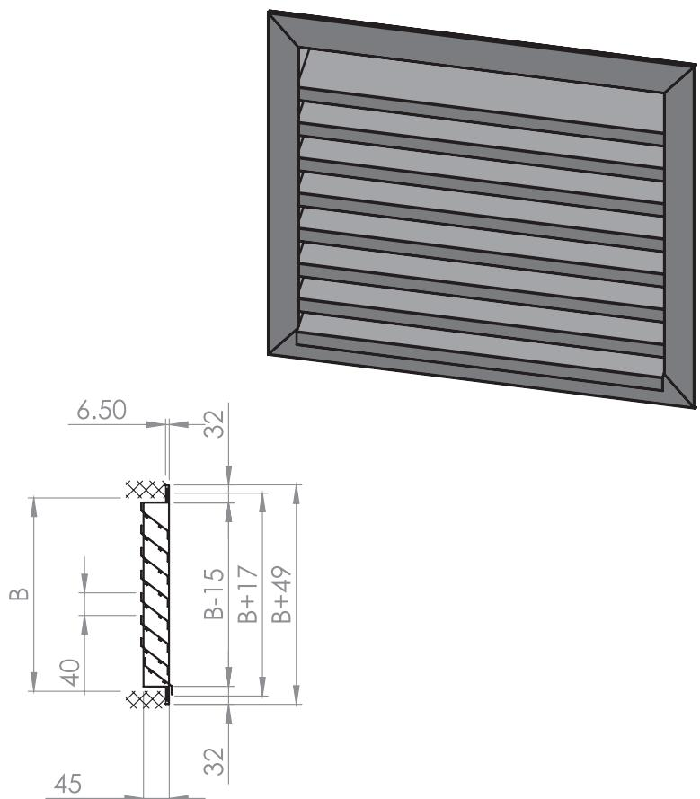
Fiksna žaluzina FŽ-L omogućava strujanje vazduha u sistemu ventilacije i klimatizacije. Ugrađuje se na spoljni zid - fasadu i služi za uzimanje svežeg i izbacivanje otpadnog vazduha. Žaluzina je snabdevena okapnicom za odvodnjavanje kao i zaštitnom mrežom od istegnutog AL protiv gmizavaca i ptica. Žaluzina je izrađena od aluminijuma eloksirano u prirodnoj boji, a na poseban zahtev može i u drugim bojama. Veličina H i B predstavljaju veličinu otvora u zidu u koji se žaluzina ugrađuje.
